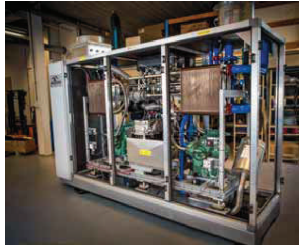
De gasmotorwarmtepomp die is ontwikkeld door Reduses.
